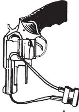
Con el cilindro abierto, inserte el cable por el cañón o por la cámara del cilindro vacío. **Para trabar:** Afioje el extremo del cable en el candado hasta que quede trabada. Quite la llave. Verifique que el cable esté asegurado.
